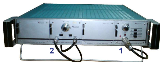
Rys. 1 (1 - zasilacz ZWN-21, 2 - dyskryminator DP-21, 3 - domek osłonowy, 4 - detektor G-M ze zintegrowanym wzmacniaczem)
